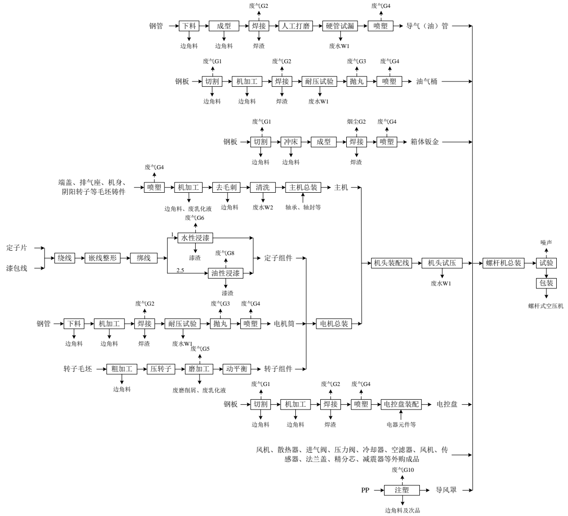
图 3-3 现有企业实际螺杆式空压机生产工艺流程图
